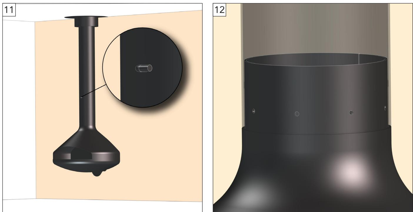
Centrez le conduit en utilisant les 8 vis plates fournies. Pour ce faire, passez par l'ouverture du foyer et accéder à l'épanouissement.
