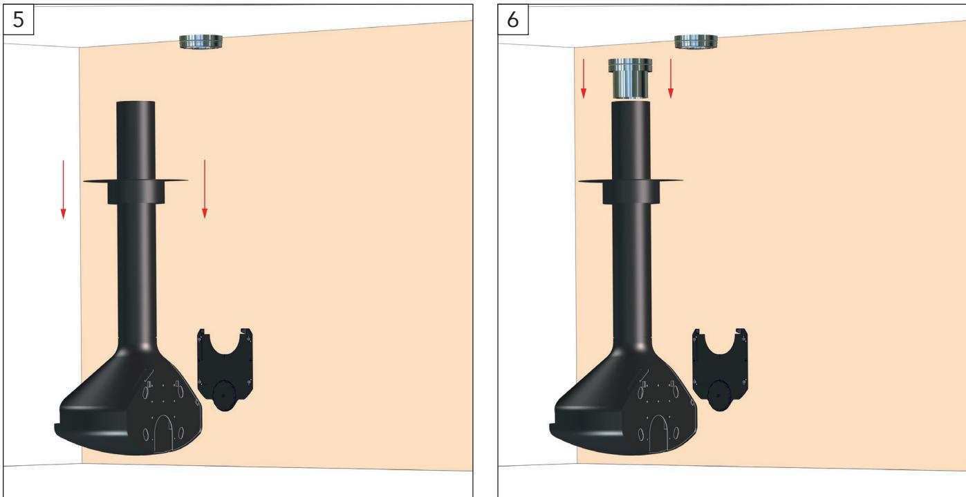
Mettre la réduction conique classe A dans l'adaptateur Focus.
