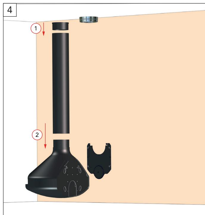
Mettre l'adaptateur Focus de 200 mm (8") en bout de conduit.
