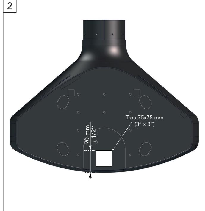
Position de la conduite d'alimentation gaz sur le mur.
